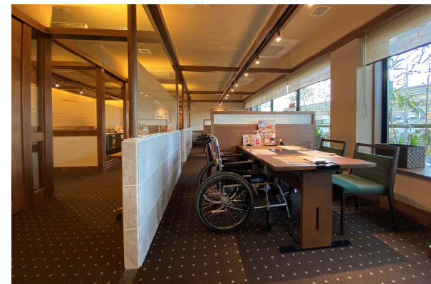
・和食レストランの通路（有効幅員150cm（写真左側））
